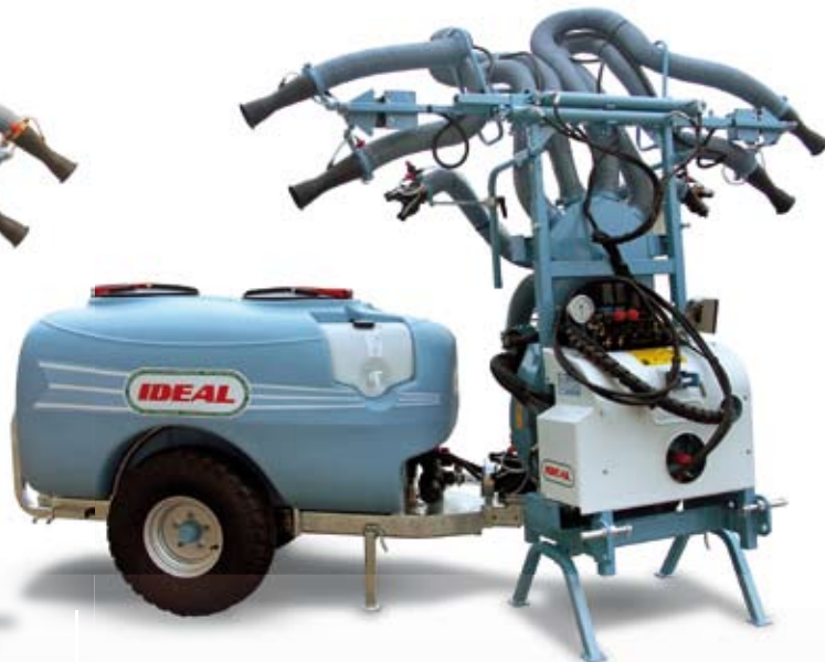
Il gruppo ventilatore, con pompa e moltiplicatore, è infatti montato in posizione fissa ai 3 punti del trattore, la cisterna è collegata al gruppo tramite uno speciale snodo che permette un angolo di sterzata di 75 gradi.
