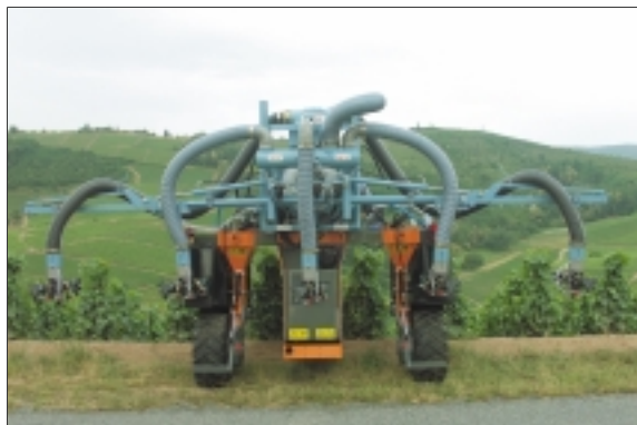
Barra di copertura chiusura ad X Rampe de couverture repliage en X
