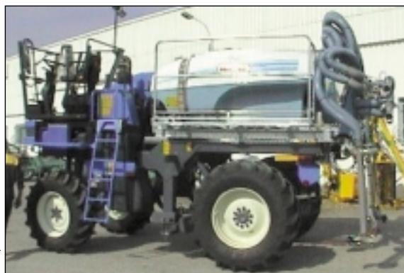
Barra di copertura con estensione idraulica / Equipaggiamento per vendemmiatrici Rampe de couverture avec extension hydraulique / Equipement machines a vendanger
