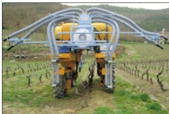
Barra di copertura con estensione manuale Rampe de couverture avec extension manuelle
