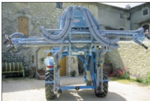
Barra di copertura con estensione idraulica Rampe de couverture avec extension hydraulique
