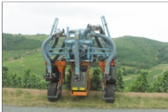
Barra di copertura chiusura ad X Rampe de couverture repliage en X
