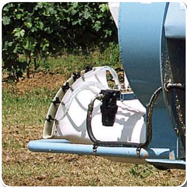
Chiusura individuale degli ugelli / dispositivo antigoccia Fermeture individuelle des diffuseurs / Dispositif anti-gouttes Nozzle individual closing / anti-drip device Individuelles Schließen der Düsen / Anti-Tropf Vorrichtung
