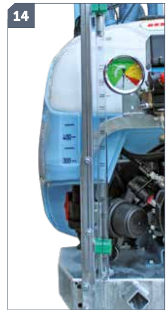
14 IT: Indicatore livello serbatoio a secco / EN: Dry gauge for tank level / FR: Jauge seche / DE: Tankpegelmesser (trocken) / ES: Indicador seco de nivel
